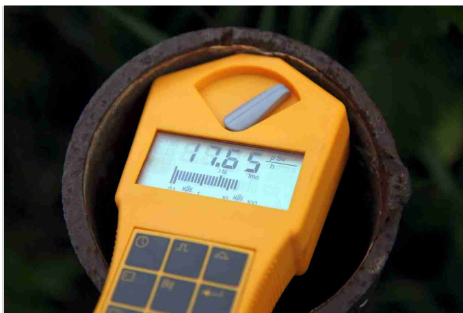
Spitzenreiter: Im Innenbereich des Zaunpfahls steigt die Ortsdosisleistung spontan auf 17,65 Mikrosievert pro Stunde an – das 126fache der Hintergrundstrahlung.
