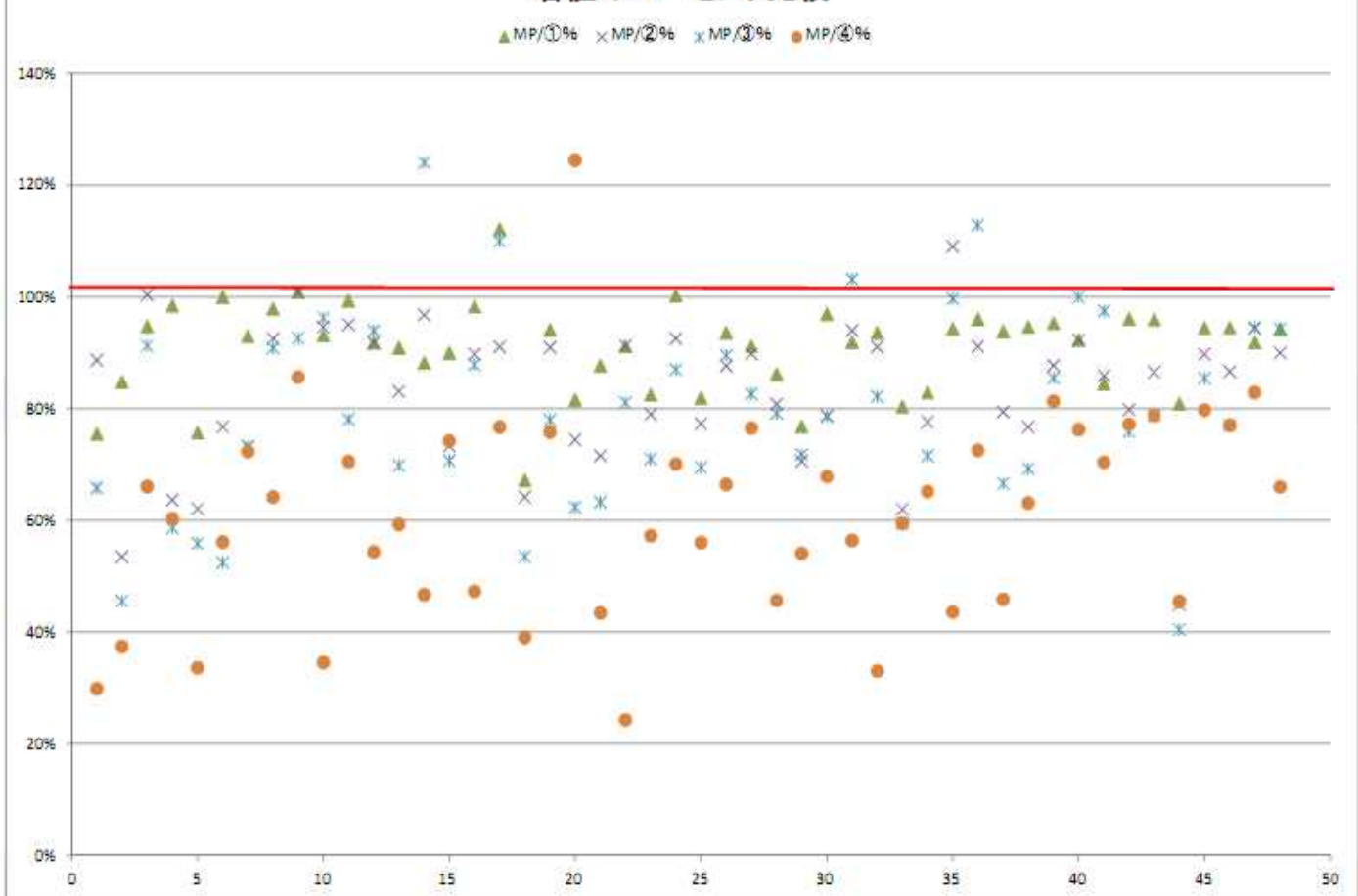
Abbildung 3: Untersuchung von 48 amtlichen Umweltradioaktivitätsmeßpunkten (monitoring posts) in Kōriyama-shi. Angegeben ist hier, wieviel Prozent das amtliche Meßgerät im Vergleich zum Wert des Hitachi ALOCA-Prüfgeräts TCS-172B anzeigt. Dabei liegt der Meßpunkt 1 (MP/①) so nah wie möglich am Sensor des amtlichen Meßpunktes, der Meßpunkt 2 (MP/②) 2 Meter vom Sensor des amtlichen Meßpunktes entfernt in 1 Meter Entfernung vom Erdboden und der Meßpunkt 3 (MP/③) 5 Meter vom Sensor des amtlichen Meßpunktes entfernt in 1 Meter Entfernung vom Erdboden. MP/④ ist der Durchschnittswert von 4 Messungen im Umkreis des amtlichen Meßpunktes in 1 Meter Entfernung vom Erdboden. Dabei wurde nach Möglichkeit über nicht-dekontaminiertem Erdboden gemessen.
