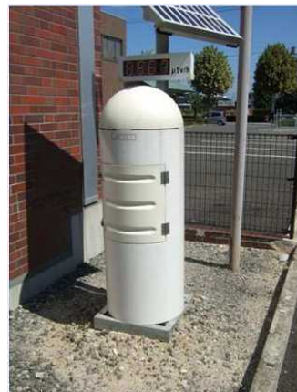
Abbildung 1: Solar betriebenes amtliches Real time Dosimeter mit Anzeige der Ortsdosisleistung in Mikrosievert pro Stunde ( \mu\text{Sv/h} )
